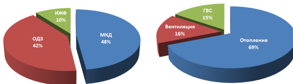
Рисунок 4.3. - Прирост тепловой нагрузки по видам теплопотребления видам и по типам зданий
